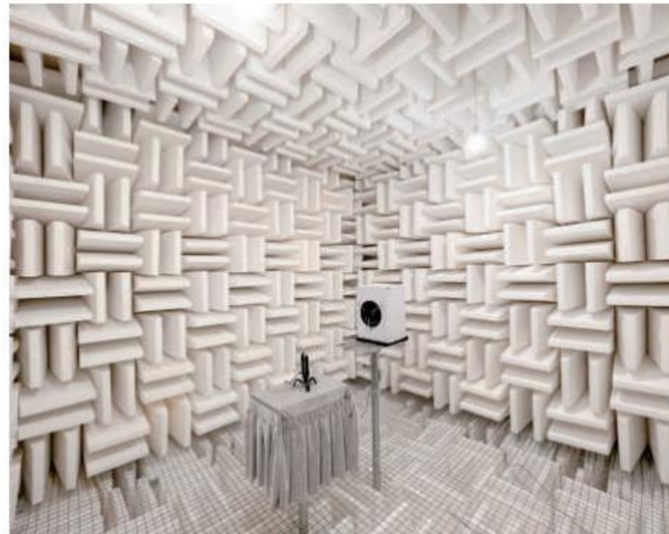
无响室 Anechoic chamber
